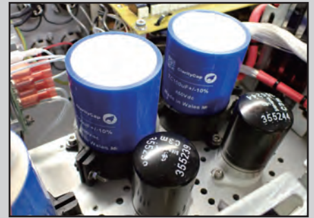
※黒色アルミカバー付の Siemens製C3m真空管と音質で定評の英国ClarityCap製フィルムコンデンサー
